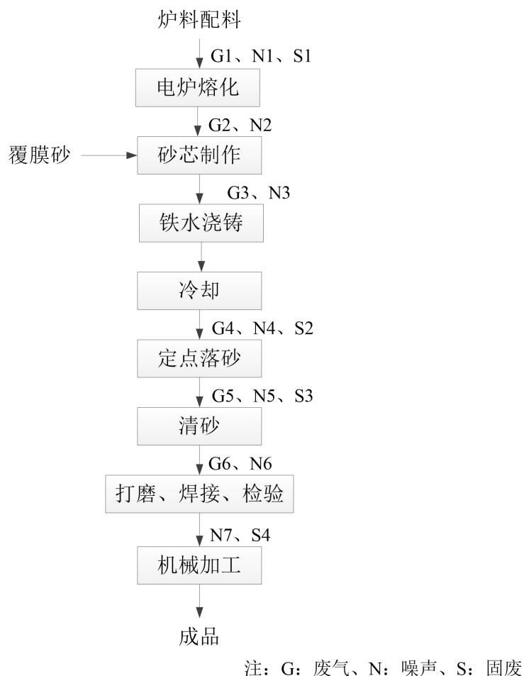
图3 生产工艺流程及排污节点图
